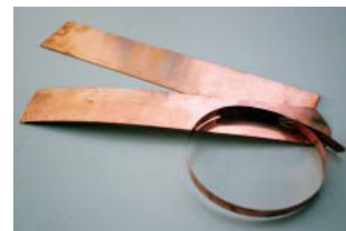
北川教授が開発した銅(手前の円状のもの)1mm以下の薄さを実現し、加工しやすい。
