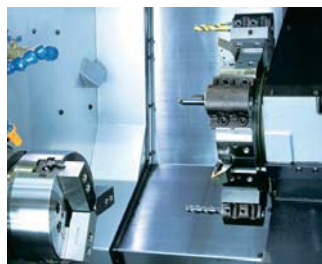
GSL-15の内部。8インチチャックと8角タレットヘッドを搭載。
