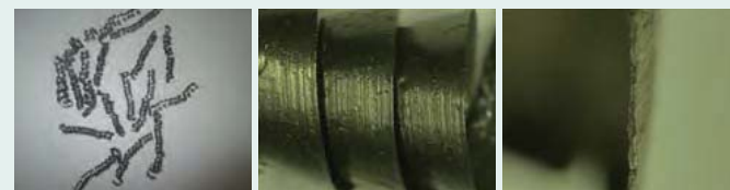
カールが小さい 規則的なカール 一定に伸びている せん断面も平ら スムーズに破断している
