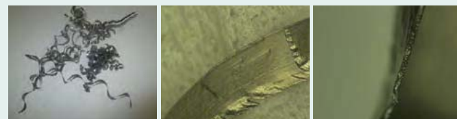
カールが大きい 不規則なカール 一定に伸びていない せん断面がのこ刃状 破断面に力が掛かった形跡あり
