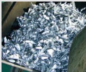
アルミストーン鑄造工場では、セミドライ加工により切屑や切れ端を乾燥工程なしで再溶解できるようになった。
