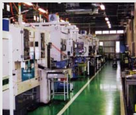
セミドライ加工によって床の油汚れがなくなった工場。床汚れが激減し、作業性も向上した。
