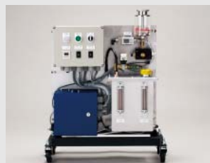
クーラントミスト装置。水溶性切削液をミスト化して噴霧する装置。
