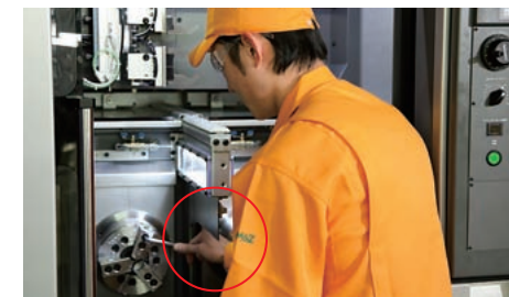
ボルト1本で取り外し可能な中間仕切り構造 (チャックの交換時に作業干渉を和らげる)
