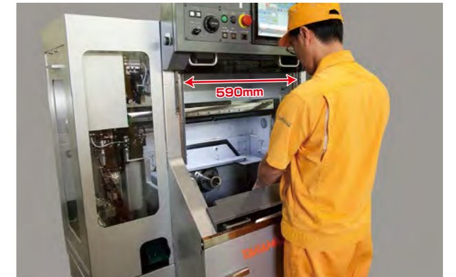
ホルダ取付位置上面が全開放するドア(特許出願中)。ドア開口部は590mm。
