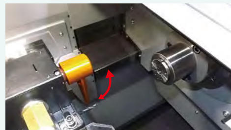
TAKAMAZ製品「XG-4」機内に搭載したウェイビーノズル。コンパクトで場所を取らない。ノズルが矢印方向にスイングし、切削油を噴射。
