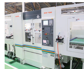
ご購入後間もないXW-130。2台分の機能を1台に統合し、工程の大幅集約を図れる
