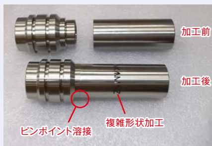
TAKAMAZレーザー複合加工機の加工例
