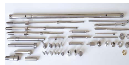
小物から長尺まで多品種ワークに対応されている。軸径公差幅「0.01mm」での加工が可能
