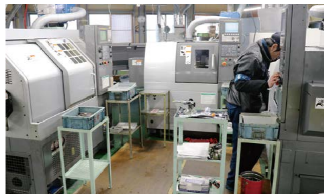
移動距離を短く、効率的に作業ができるよう、1人の作業員の周囲にくるりと機械を配置
