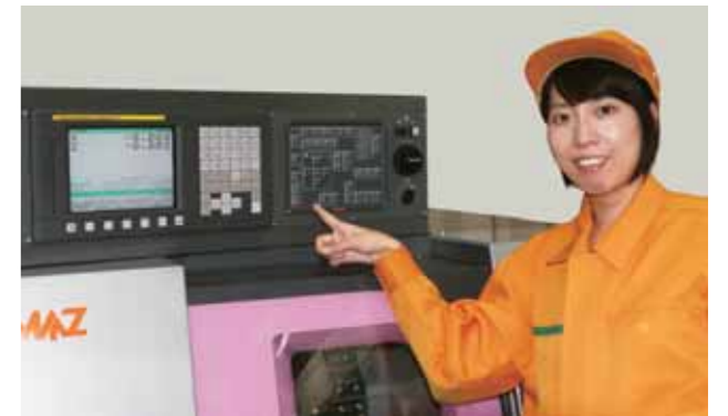
人間工学に基づいた操作盤は女性が作業しやすく、操作頻度の高いボタンは作業者の右側に集中配置されている(写真の女性は、GSL-10Hの開発者 当社開発課係長 宮山)
