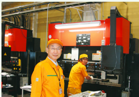
板金を曲げるプレスブレーキマシン
