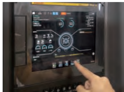
FCローダ仕様の制御画面。 10.4インチのタッチパネル 式が採用されている。
