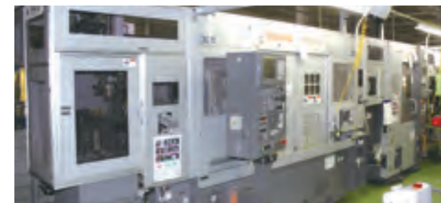
工場内にある、TAKAMAZのXD-10iとXL-100を連結した製造ライン
