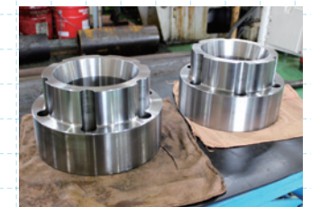
TAKAMAZ製品の要とも言える、同社製造のプーリやフランジ。部品精度を高めることで、工作機械の性能UPにも貢献していただいている。
