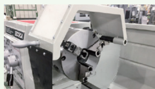
主軸芯高 1,000mm なので、オペレータの体への負担が少ないです。
