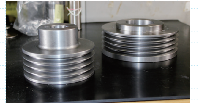
TAKAMAZ製品の要とも言える、同社製造のプーリやフランジ。部品精度を高めることで、工作機械の性能UPにも貢献していただいている。
