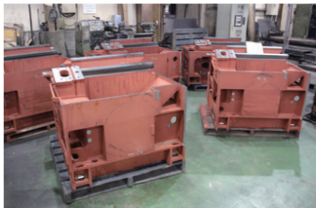
同社製品の一部 写真はTAKAMAZの各種工作機械を支えるベッド
