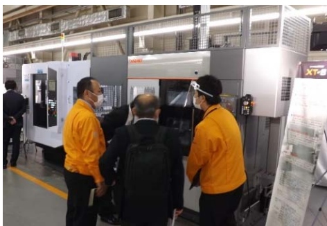
当社製品「XT-8」とメクトロン社製タッピングセンタの連結機
