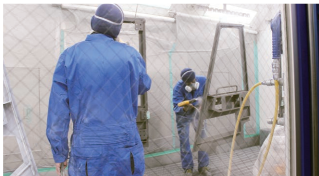
無溶剤塗装の一種「粉体塗装」を行っている現場。粉状の塗料を吹き付けておりこの後、加熱炉にて塗料を溶かすことで完成する。
