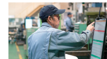
現場でIoTシステムを使用している様子。タッチパネル式で分かりやすい操作画面にすることで、現場でのシステム操作時間も短縮できるように工夫されている。
