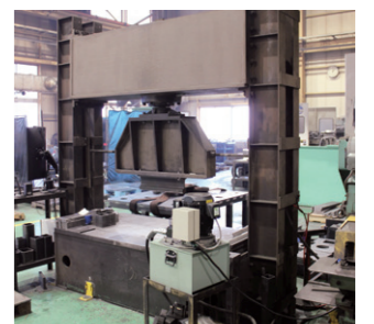
山田会長が独立当初に自作した、溶接によって曲がった製品を戻すプレス機。現在でも現役で活躍し、同社のモノづくりを支えている。
