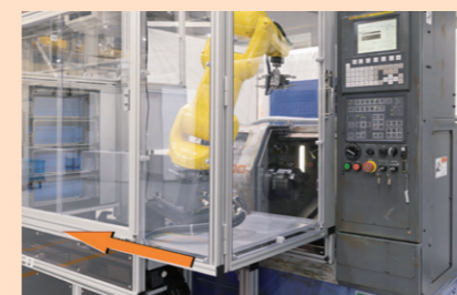
固定具を外し押すことで、ロボットと安全フェンスがスライドします。
