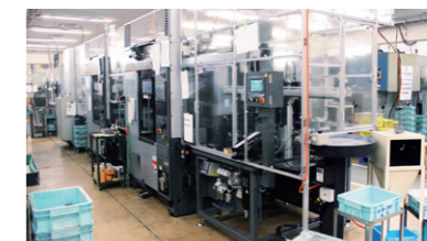
工場内にTAKAMAZの機械はすべて一つのエリアに集められ、油圧ポンプ部品の生産ラインを形成しています。
