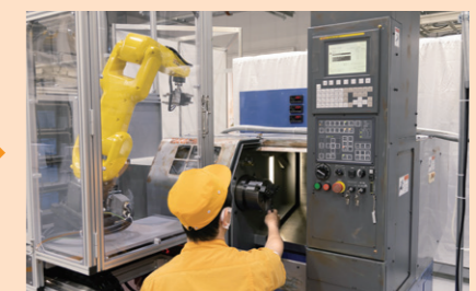
旋盤のメンテナンスなどの作業後、製品上部を戻し加工を再開。製品自体の移動がないため、素早く加工を再開することができます。
