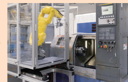
スライド移動後、旋盤の加工室での作業スペースができます。
