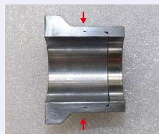
溶接部断面 矢印は溶接箇所
