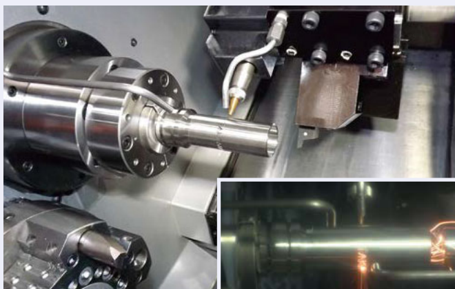
切削加工・複合加工に加え、 レーザー加工も可能
