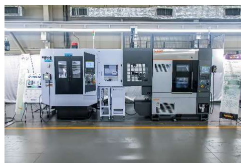
当社製品「XT-8」とメクトロン社製タッピングセンタの連結機
